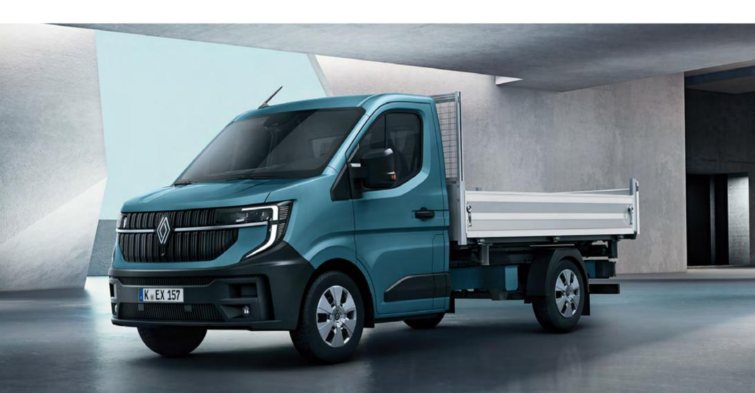
Ausführung Kipperaufbau mit Einzelkabine
