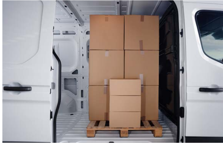
Flache, nicht in den Laderaum hineinragende Trennwand und 1.312 mm breite Schiebetür-Öffnung
